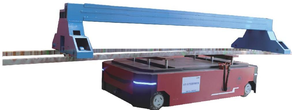
■ 双轮组逆向旋转机构：通过伺服驱动PLC 控制，独立算法，双轮逆向差速旋转，实现精确定位，精准到达、瞬间刹车，实现横向行走、纵向行走、原地360° 旋转、斜线行走、曲线行走、灵活动作。支持圆弧转弯差速运动。电机采用国际或国内顶端品牌，确保产品的稳定性。
